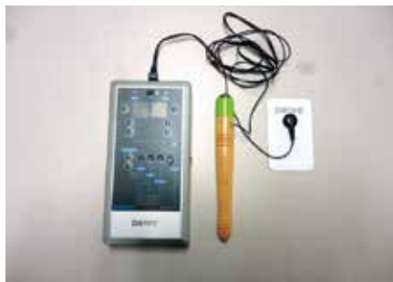
嚥下リハの機器（表面電気刺激DRIVE）も新しくなりました
