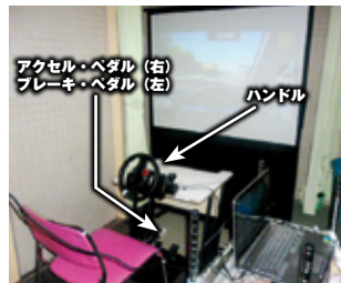
ドライビング・シミュレーター 自動車運転に関する一連の動作を検査、 訓練できるシステム
